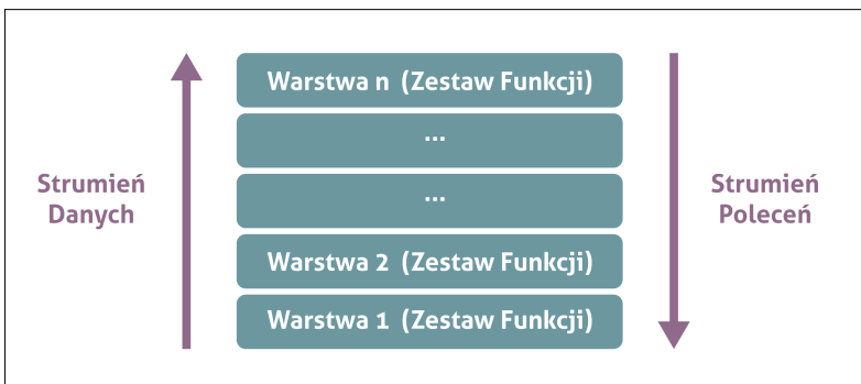
Rysunek 7. Schemat warstwowego modelu referencyjnego.
